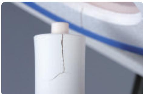
Détecteur électronique de fissuration des cylindres – CDS
