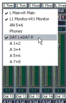
Les sorties physiques (troisième rangée) peuvent être éditées de la même façon. Dans ce cas, les noms dans les menus déroulants de routage changent automatiquement. De plus, les noms des menus déroulants de la section Monitor changent aussi.
