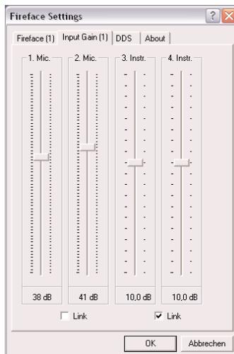
Dans la plage inférieure, les faders sautent de 10 dB à 0 dB. Ce réglage supplémentaire utile permet d'utiliser même des signaux ligne avec l'entrée microphone (jusqu'à +10 dBu).
