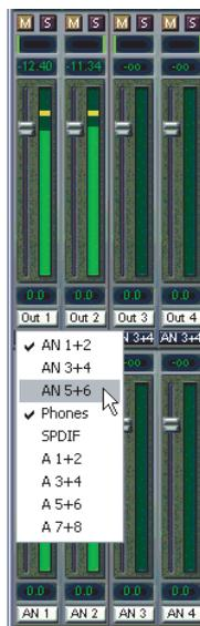
Dans la rangée inférieure, sur le canal 5, vous pouvez aussi voir le niveau de ce que vous écoutez. L'indicateur de niveau de sortie physique affiche le niveau de sortie. Cliquez sur la zone au-dessus du fader et faites glisser la souris pour régler le panoramique, soit dans ce cas le routage entre les canaux 5 et 6. La valeur actuelle de panoramique est affichée sous le fader. Veuillez maintenant faire de même pour Out 2 afin de la diriger également vers la sortie 6.
