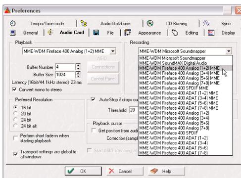
Augmenter le nombre et/ou la taille des mémoires tampons (buffers) audio peut empêcher les ruptures de flux de signal audio, mais aussi augmenter le temps de latence c'est-à-dire que la sortie est retardée. Pour une reproduction synchronisée de l'audio et du MIDI (ou similaire), cochez "*Get position from audio driver*" (Obtenir la position du pilote audio).
