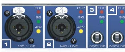
Les entrées 3/4, **INST/LINE** (instrument/ligne), acceptent aussi bien un signal ligne symétrique qu'un signal d'instrument asymétrique sur fiche jack 6,35 mm 3 contacts.
