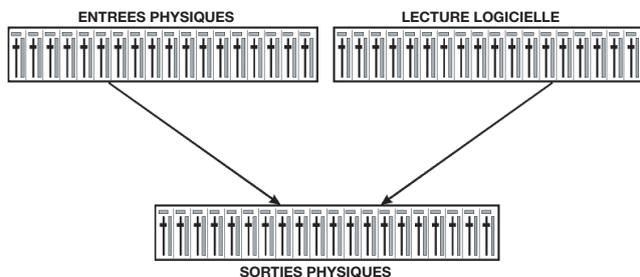
36 canaux ne tiennent pas côte à côte à l'écran et un tel arrangement ne fournirait pas une vue très utile. Les canaux d'entrée doivent être placés au-dessus du canal de sortie correspondant. Par conséquent, les canaux ont été arrangés comme sur ce que l'on appelle une console de mixage *Inline*, afin que la rangée de lecture logicielle corresponde au retour magnétophone (*Tape Return*) d'une véritable table de mixage.
